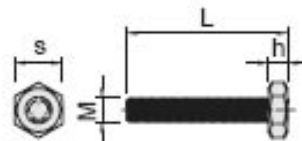
Longueur "L" des vis des vérins distanceurs en fonction du vide "b"
