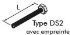
Longueur "L" des vis des vérins distanceurs en fonction du vide "b"
