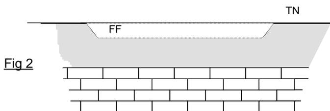
Le niveau de fond de fouille est à un niveau supérieur au sol d'assise de la fondation
