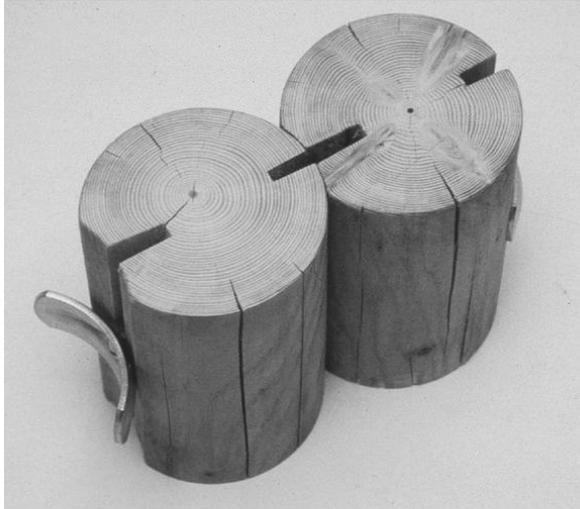
L'apparition de ces fentes peut être limitée en créant des entailles de décharge pour les pièces soumises aux retraits importants.
