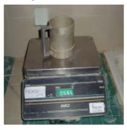
Verser le matériau dans la récipient calibré jusqu'au refus avec les mains formant entonoir et situées à 10 cm au dessus du récipient.
