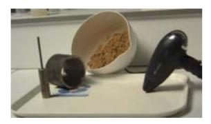
Exposer le sable à un flux d'air chaud en le remuant pour assurer un séchage uniforme en veillant à ne perdre aucun élément du sable.
