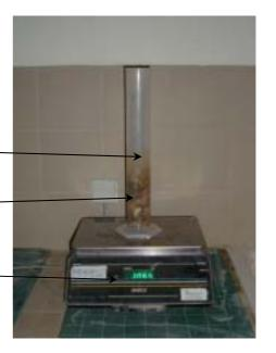
La masse volumique réelle est donnée par :  $\rho_r = (M2 - M1) / (V2-V1)$
