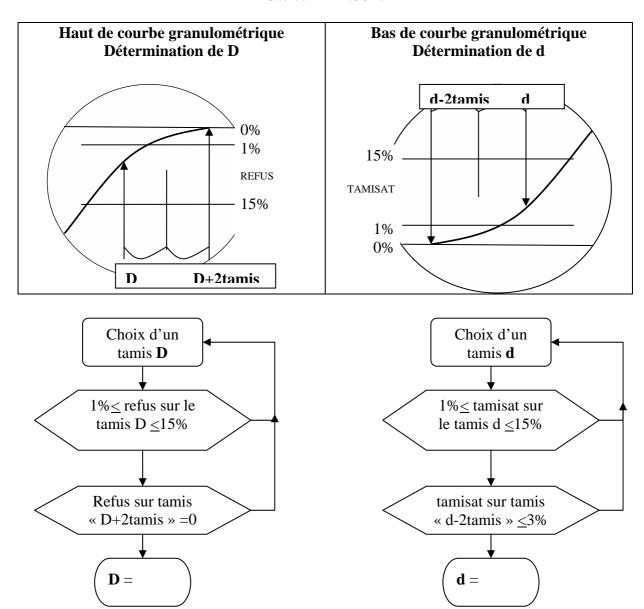
NB; Si on trouve d<2mm alors la norme impose d=0 le granulat est alors un 0/D
