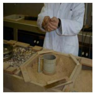
Araser le granulat (dans 2 directions perpendiculaires) avec une règle à araser, de telle sorte à remplir parfaitement le récipient. Attention à ne pas tasser le matériau lors de cette manipulation
